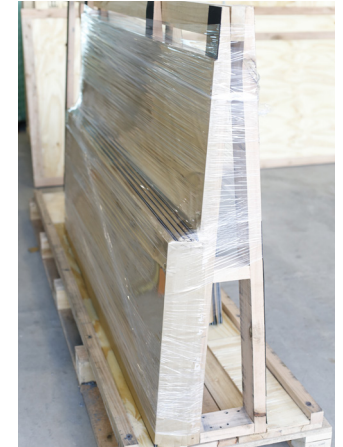
Die ideale Lagerung von CORSTONE-Platten über einen längeren Zeitraum sollte auf handelsüblichen Glasböcken mit einem Winkel von circa 6° erfolgen.
