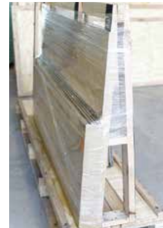
O armazenamento ideal das placas de CORSTONE por um período mais longo deve ser em cavaletes com uma angulação de 6° da base em relação ao encosto e o encosto deve ter várias travessas para garantir o total apoio das placas.
